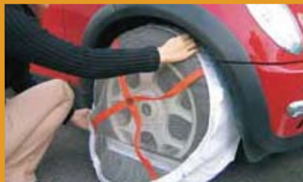
タイヤの裏側にゴムがくるように上半分をかぶせます
