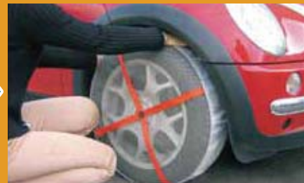
残り半分をタイヤにかぶせれば取り付け完了!!
